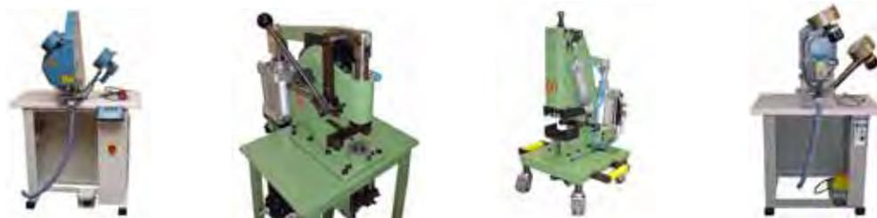
*Permet la pose de l'ensemble de notre gamme d'œillets en une seule opération. Certaines disposent d'un distributeur automatique. Nous consulter pour connaître le modèle adapté à vos besoins.*
